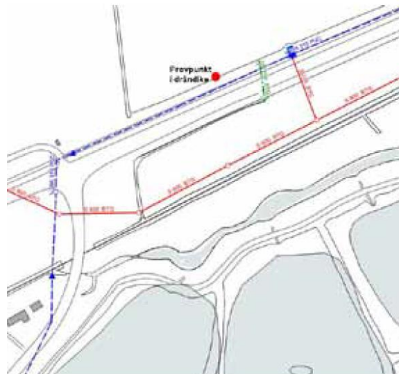
Bild 12. Plats för prov i vägdike. Gröna linjer anger dagvatten
